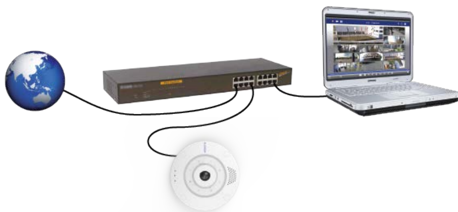
図15：PoE Plus（802.3at-2009）に準拠したPoEスイッチによる電源供給。
