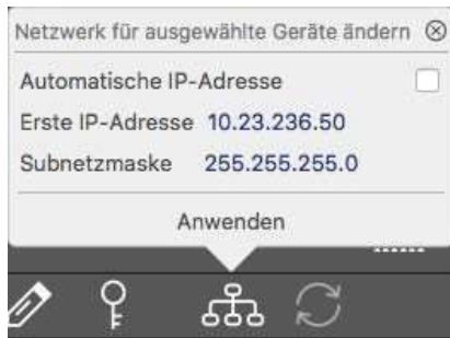
図24 : 選択したデバイスのネットワーク設定を変更する
