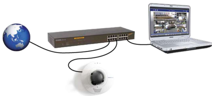
図17 PoE Plus（802.3at-2009）に準拠したPoEスイッチによる電力供給。
