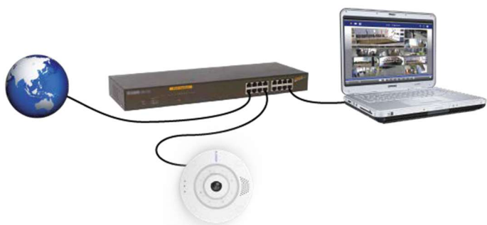
図17 PoE Plus（802.3at-2009）に準拠したPoEスイッチによる電力供給。
